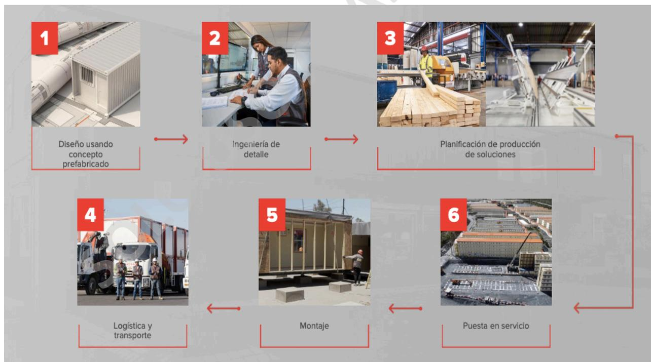
Imagen 13: Fases de una Construcción Modular.
