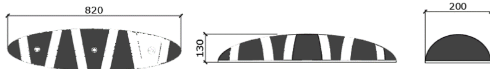
DETALLE SEPARADOR ZEBRA 13. 820x130x200mm. ESC. 1:10
