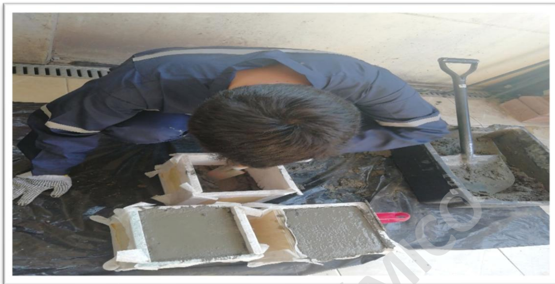
Imagen N°9: Probetas en etapa de compactación manual, otra vista.
