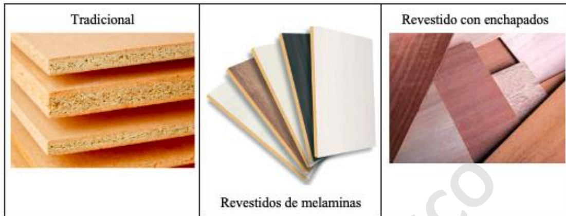
Figura 11. Tipos de tableros MDP
