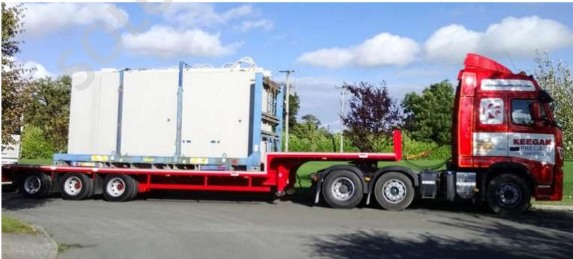
Figura 23 - Transporte paneles prefabricados de hormigón, fuente Keegan precast
