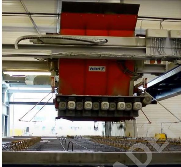
**Figura 18 - Proceso de hormigonado fuente Vollert.**
