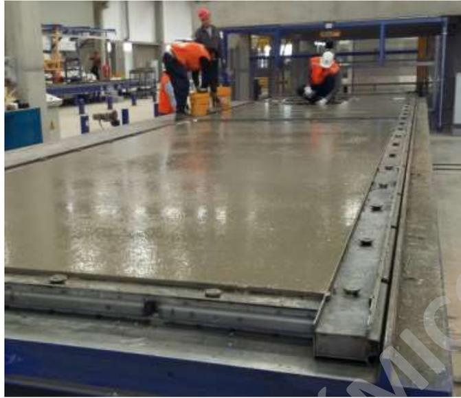
Figura 19 - Proceso de alisado de paneles – fuente Vollert.
