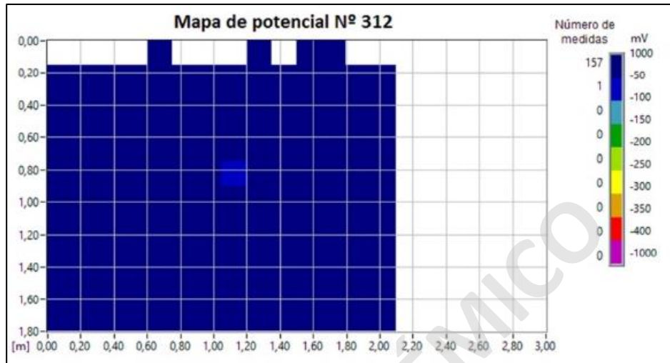
Imagen N.º 47: Potencial de Corrosión torre norte, (cara noroeste expuesta al río).
