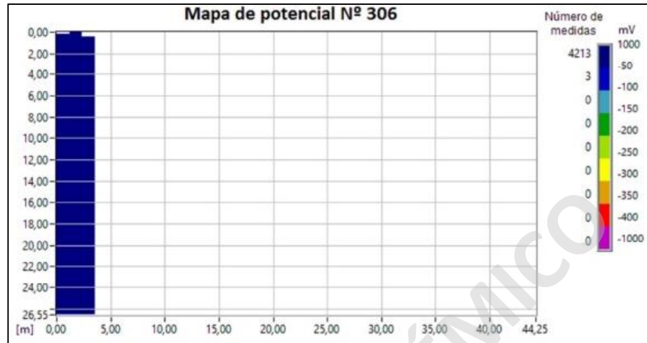
Imagen N.º 41: Potencial de corrosión tablero, (desde punto norte 26m hacia el sur)
