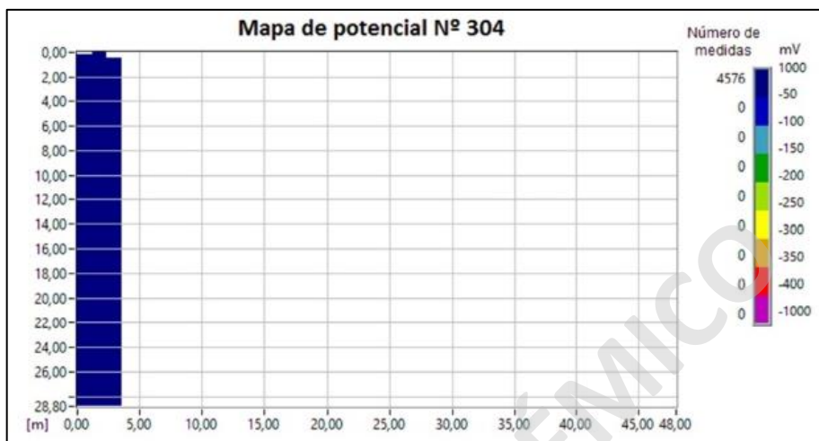
Imagen N.º 39: Potencial de corrosión tablero, (punto sur 28m hacia el sur)
