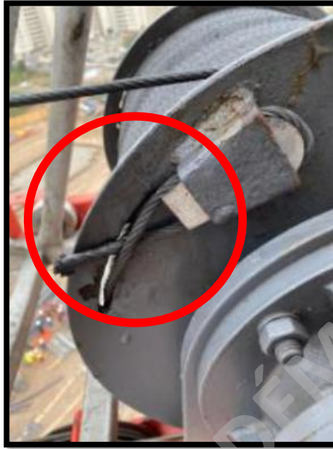
Imagen N°47: Ausencia de Prensa - Tambor de enrollamiento
