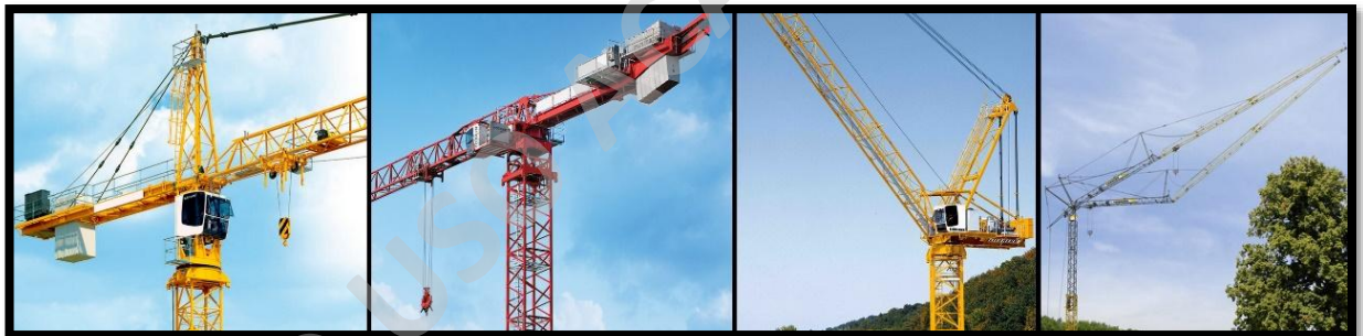
Imagen N°16: Diferentes Tipos de Pluma - Grúas Torre.
