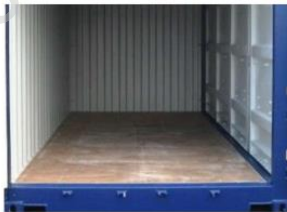
Imagen n°6: Piso de un contenedor marítimo. Fuente: Contenedores Marítimos, 2016.
