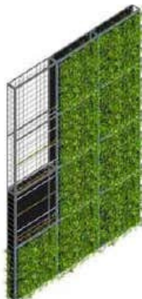
Fig. 14 Axonométrica panel caja metálica fuente https://www.academia.edu/28601867/Fachadas_vegetales
