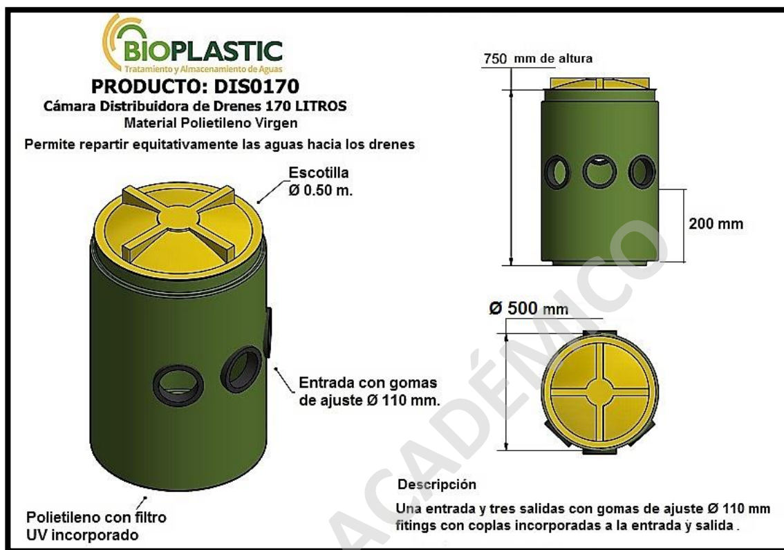
Imagen N° 15: Cámara Repartidora de Drenes.
