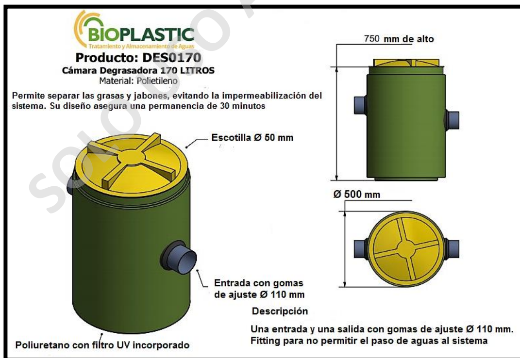
Imagen N° 3: Cámara Interceptores de Grasa y Jabones de Plástico.
