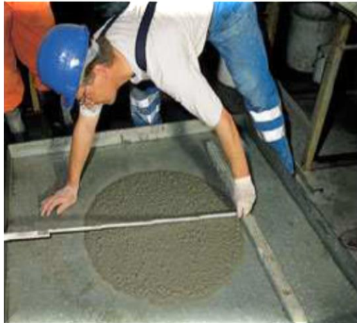
Ensayo de escurrimiento
