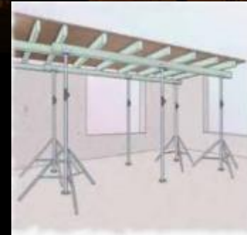
Moldaje de losas
