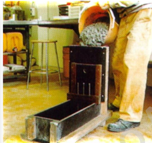
Ensayo caja L
