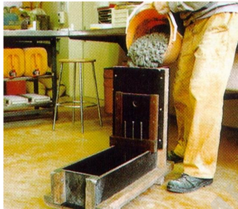
Imagen N°2.Ensayo de caja L
