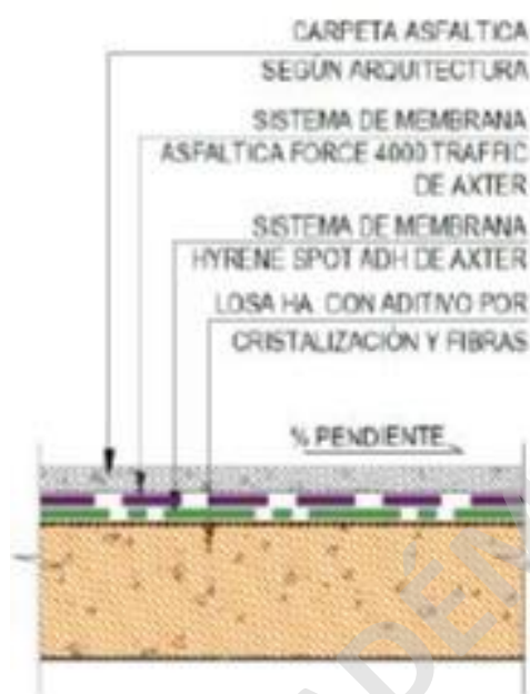
Figura 23: Estratigrafía de zonas de tránsito vehicular
