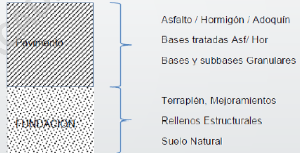
Imagen 29: Fundación y Pavimento
