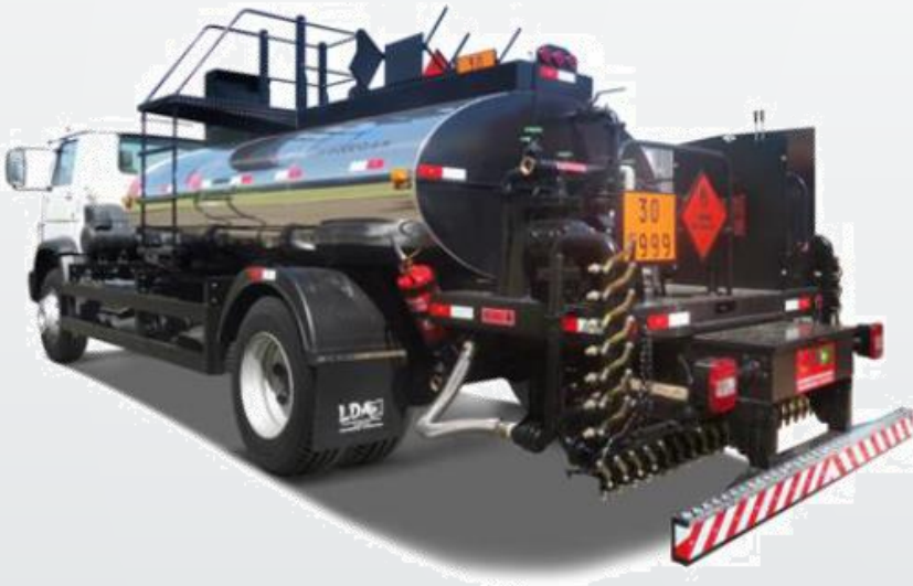
Imagen 50: Regadora de Asfalto
