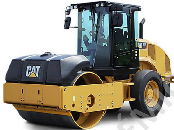
Imagen 41: Rodillo Compactador Liso
