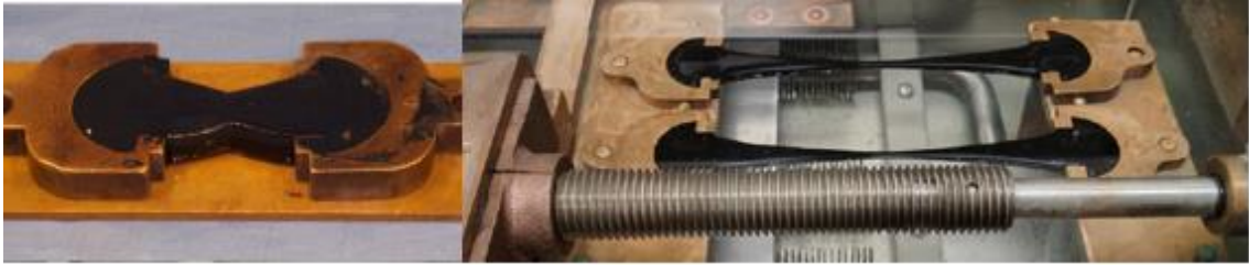
Imagen 7: Ensayo de Ductilidad
