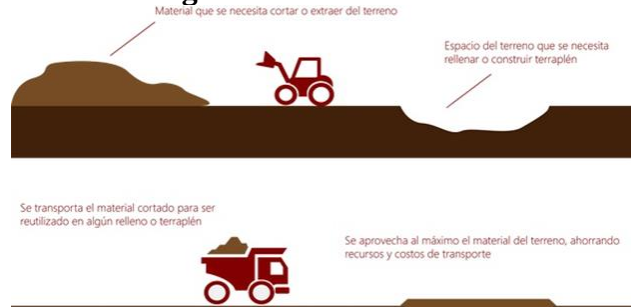
Imagen 60: Relleno de Terreno
