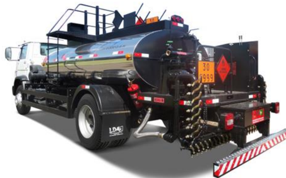
Imagen 50: Regadora de Asfalto
