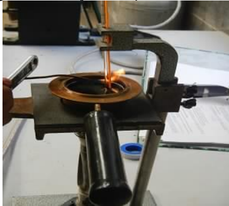
Imagen 12: Ensayo en copa abierta Cleveland
