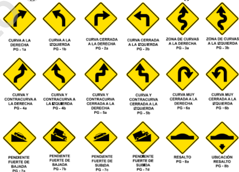
Imagen 85: Señales de Advertencia de Peligro
