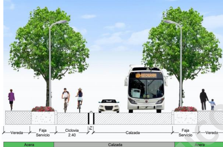
Imagen 31: Corte de Calzada Tipo
