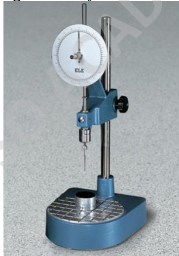
Imagen 8: Ensayo de Penetración
