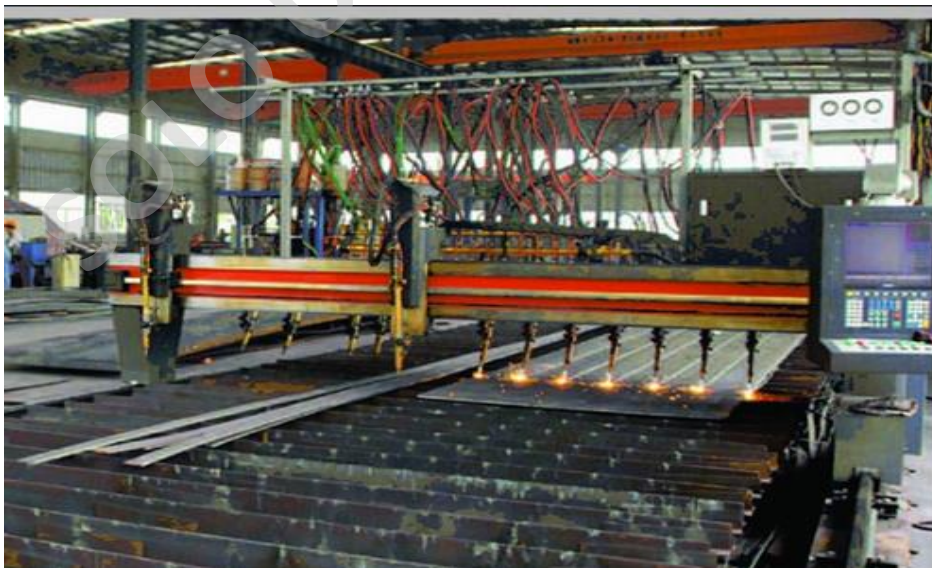
Figura 17 Proceso Oxicorte CNC
