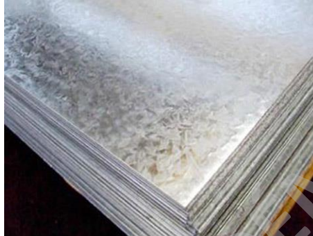
Figura 37: Plancha lisa Galvanizada.
