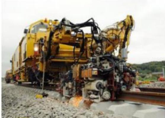
*Foto 78.-Camión Soldador. Soldando rieles en campo mediante chisporroteo.*
