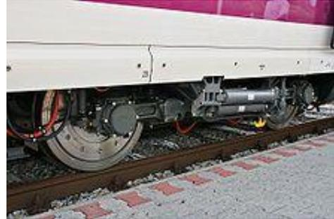
Foto 56.- Tracción distribuida, "Bogies" Siemens Velaro E/AVE Serie 103.
