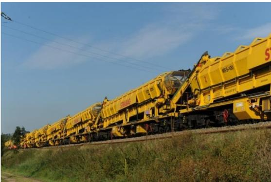
Foto 87.- Máquina Transportadora de Materiales. Serie MFS. Logística de Materiales.
