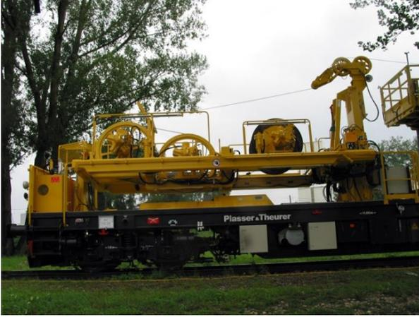
Foto 88.- CEM 100.223. Instalación de Catenarias.
