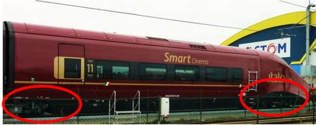
Foto 58.- 2 Bogies por vagón, uno entre dos carros del AGV ITALO en círculos rojos.
