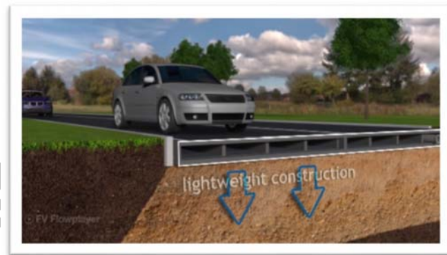
Figura N°12 – Concepto de estructura de Plastic Road.
