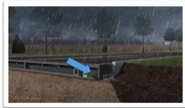
Figura N°11 – Concepto de filtración de agua de Plastic Road.
