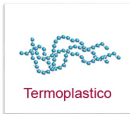
Figura N°20 - Estructura Molecular Termoplástico.
