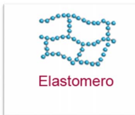
Figura N°22 – Estructura Molecular Elastómero.
