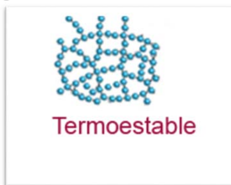
Figura N°21 – Estructura Molecular Termoestable.
