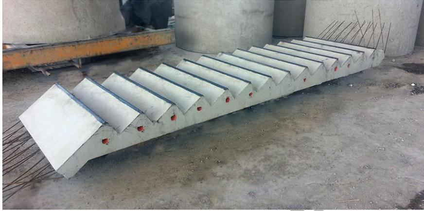
*Ilustración 17 - Escalera prefabricada en hormigón*
