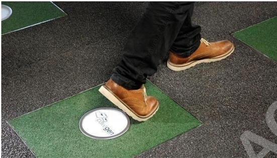
**Imagen 2: Dispositivo piezoeléctrico instalado en Londres**
