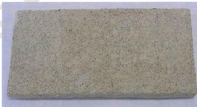
Figura 3-4 Muestra preparada para la medición de degradación de \text{NO}_x Fuente: http://prefabricadosjara.com/pdf/IT120054LAJARA.pdf
