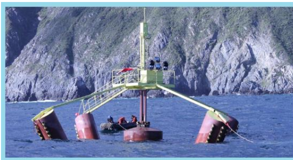
Figura 2. 5 Cinfuncho II es un equipo undimotriz, capaz de obtener energía del movimiento de las olas.
