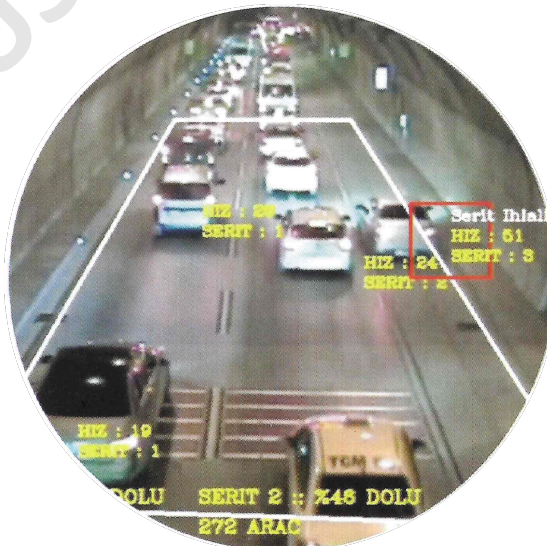
Figura 94. Sistemas de circuito cerrado de televisión y detención de incidentes Fuente: ISBAK, Architect of Smart City, año 2018
