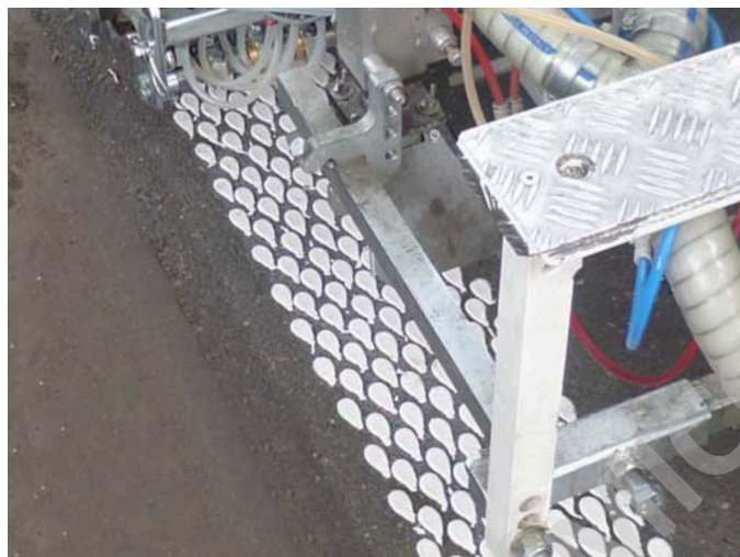
Figura 78. Demarcación Termoplástica Multipunto en forma de Gota Fuente: Hoffman – Road Marking Systems
