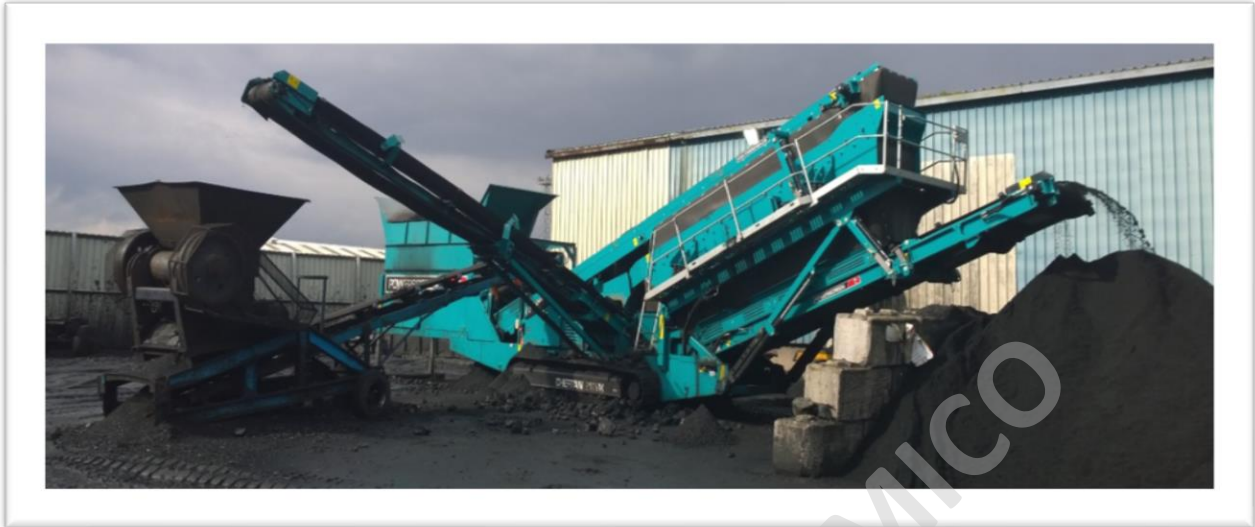
Imagen 43.- Planta procesadora móvil (Chieftain 1200x 3 Dock)
