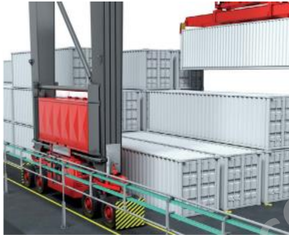
77.- Solución barra conductora (Busbar Retrofit).
