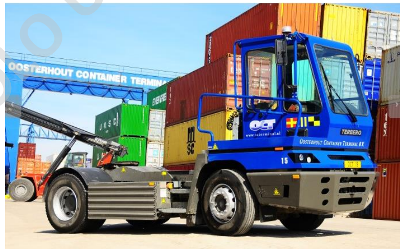
80.- Cabeza tractor totalmente eléctrico (Terberg YT202-EV) implementado en puerto de Rotterdam, Holanda.
