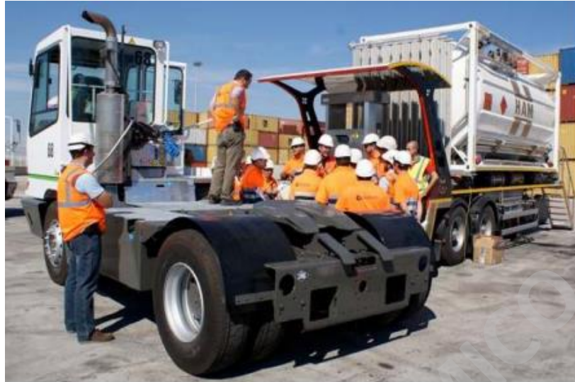
81.- Cabeza Tractora y Camión de suministro de GNL en Noatum Container. Fuente: (Eficiencia Energética en Puertos: Tendencias y Mejores Prácticas, Comisión interamericana de puertos. 2016).
