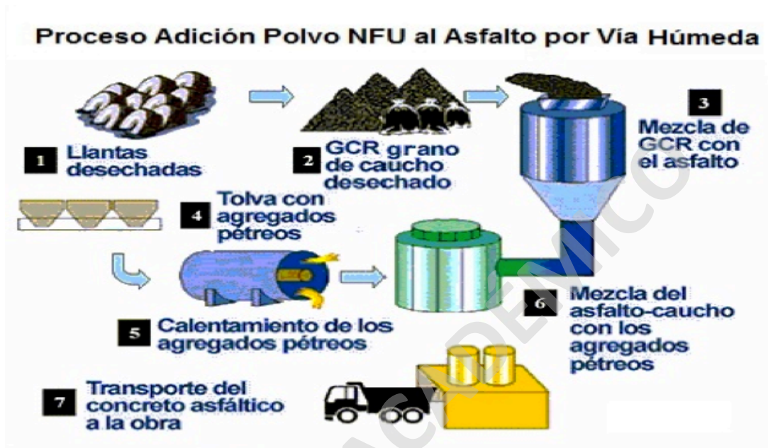
Ilustración 20, fabricación asfalto-caucho por vía húmeda
