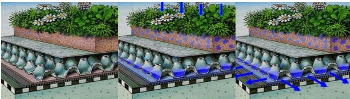
Figura 2.55 Procedimiento de liberación de agua.
