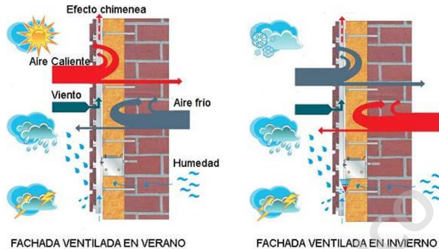
Figura 12 funcionamiento por estacion del año
