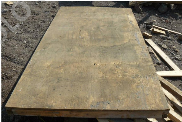
Figura 19 :Placa Carpintera con restos de hormigón.
