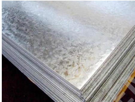
Figura 37: Plancha lisa Galvanizada.
