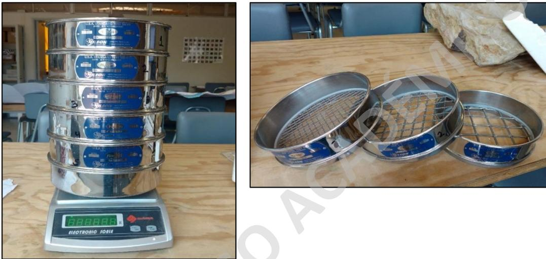
**Figura 3** Equipo de laboratorio para procedimientos de tamizaje. En la imagen izquierda se muestra la balanza digital y los tamices con norma ASTM, mientras que a la derecha se muestran las mallas de los tamices gruesos.
