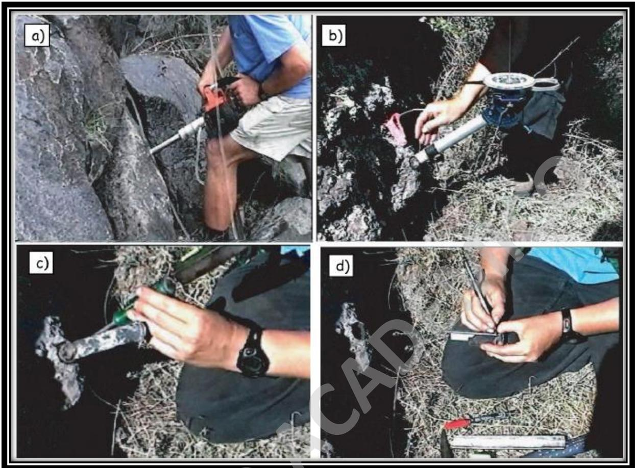
Figura 19: Procedimientos para la toma de muestras de AMS. A) Perforación. B) Orientación de la muestra. C) Extracción de la muestra. D) Rotulado de la muestra. (Extraído de Chadima, s.f.)
