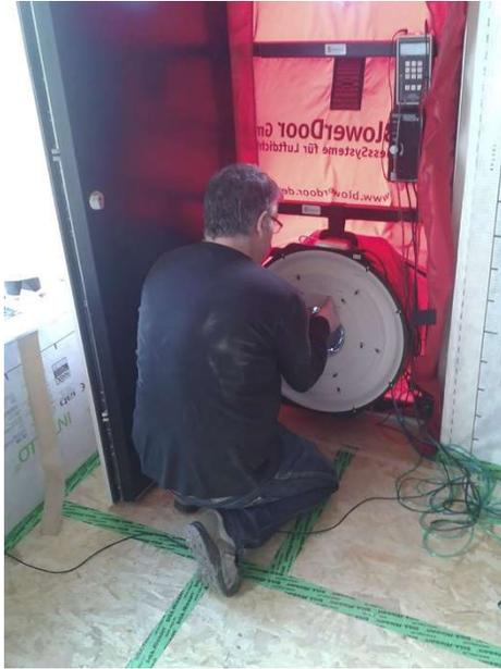
Figura 52: Ensayo Blowerdoor en casa pasiva, ESHAUS.
