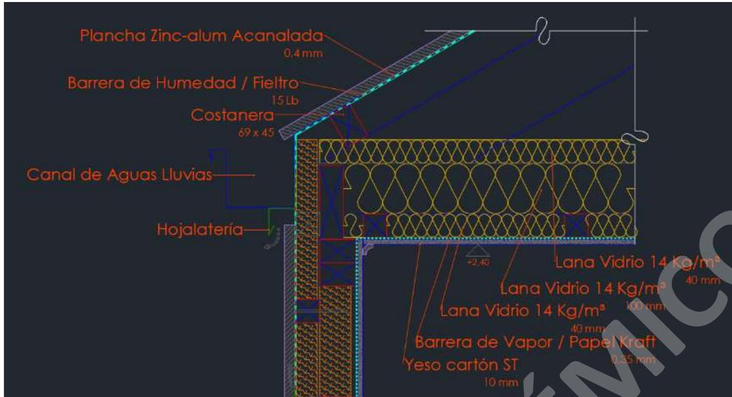
Figura 123: Configuración de materiales de la envolvente de la Techumbre
