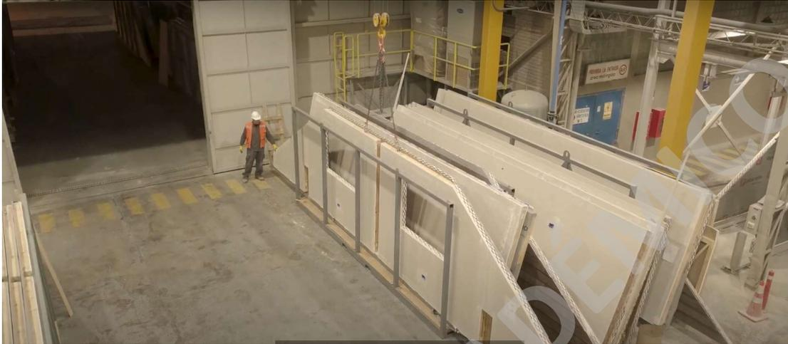
*Figura 95: Módulos panelizados listos para transporte y posterior montaje en obra.*
