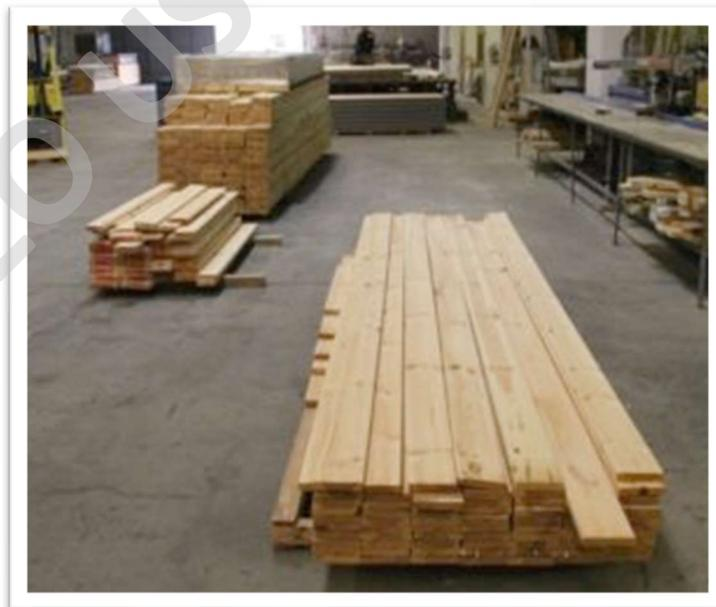
*Figura 86: Piezas cortadas según planimetría para formar la estructura de muros y techumbre.*
