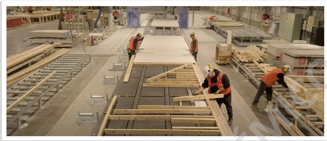
*Figura 88: Proceso de armado y fabricación de los entramados verticales, módulos panelizados.*
