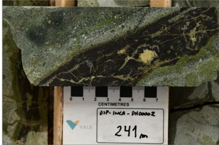
Figura 21: Fragmento de sondaje correspondiente al pozo número 2, que cuenta con alteración y mineralización caracterizada como de tipo IOCG. Extraído de reportes internos de Vale.
