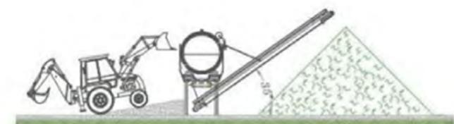
Figura 52: Esquema resumen del proceso que realiza la maquinaria en el proceso de compostaje. Imagen obtenida de Google.
