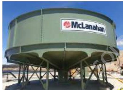
Figura 23. Espesador de Relave prefabricado en altura. Fuente:
