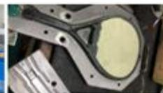
Saque la raqueta de moldeado de la mesa de prensado en caliente para el siguiente proceso de pulido.
