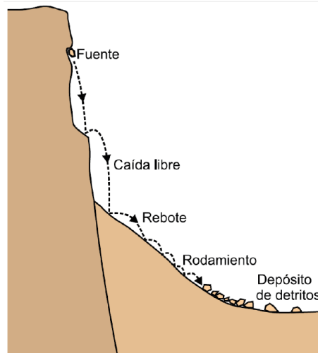
Figura 3.1. Esquema caída de roca. Extraído de Proyecto Multinacional Andino (2007).
