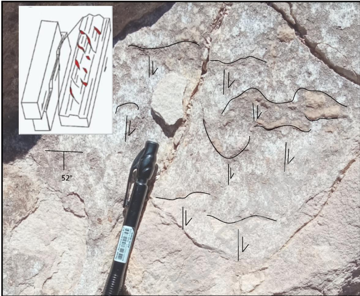
Figura 36 : Ejemplo de falla normal Estación 2. Se aprecian fracturas tipo R como sombras de presión, en el plano principal M. Al mismo tiempo se puede observar estrias de falla con crecimiento de fibras mineral, con flechas que indican el sentido de movimiento del bloque faltante.
