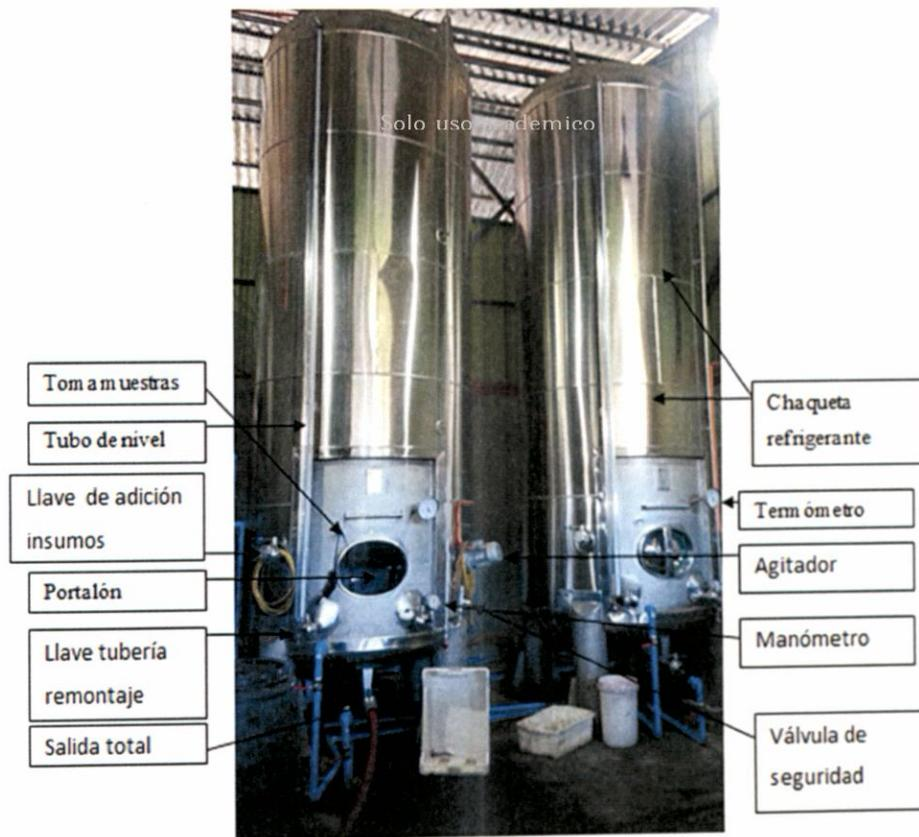
Figura N°16: Estanques Charmat Fuente: Elaborado por el autor.
