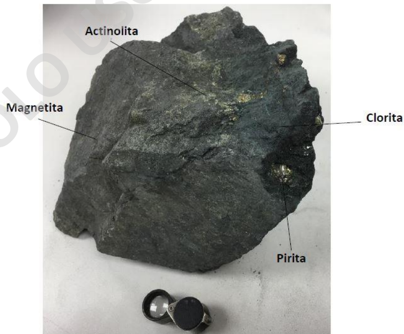
Figura 17: Actinolita en parches alterada por clorita, y mineralización de pirita.
