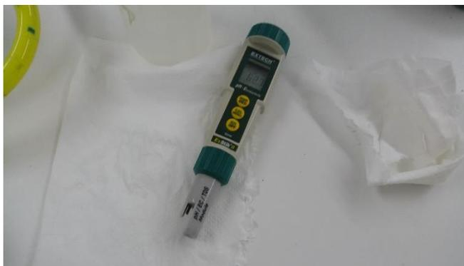
Figura 31. Medidor de conductividad eléctrica portátil utilizado en medición en laboratorio. Elaboración propia.
