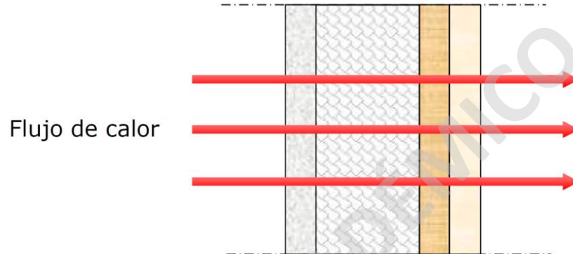
Imagen N° 9: Flujo de calor atravesando un elemento homogéneo.
