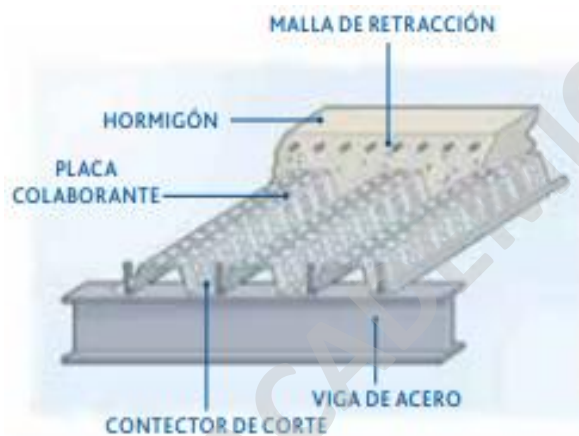
Imagen N °10. Montaje de losa colaborante. (Fuente: Manual de moldajes, CChC, 2014)
