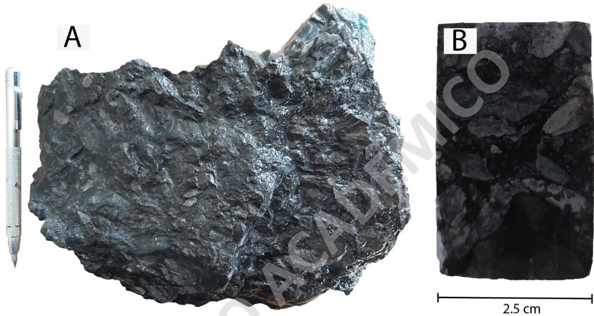
Figura 14: Brecha hidrotermal mineralizada. A. Fotografía de muestra de mano. B. Rechazo de la sección pulida PO-11, donde se aprecia claramente los clastos y la matriz de brecha.
