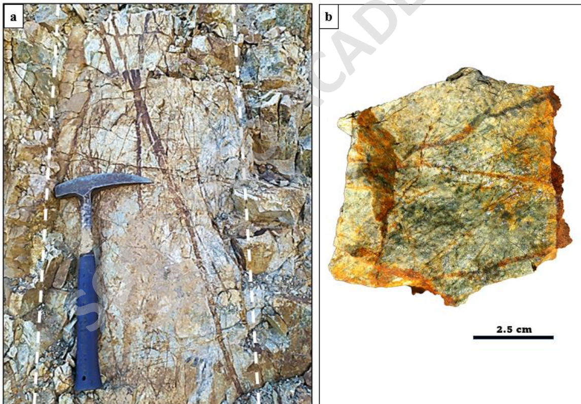
Figura 17. Fotografías de diques andesíticos del depósito Cerro del Oro. a) Afloramiento con dique andesítico cortado por enrejado de vetillas de cuarzo, producto de las alteraciones potásica y sericítica, así como alteración supérgena tardía (hematita-goethita). La línea punteada indica la orientación principal del cuerpo tabular respecto al intrusivo. b) Muestra de mano del dique andesítico (COR-06) con fenocristales de plagioclasa y cúmulos de biotita junto a vetillas de cuarzo, producto de las alteraciones potásica y sericítica, así como de una alteración supérgena tardía (hematita-goethita).
