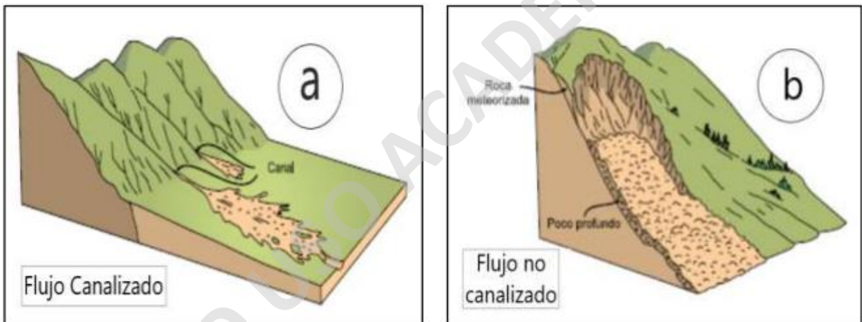
Figura 3.3 Flujo canalizado (a) y flujo no canalizado (b), modificado de Cruden y Varnes (1996).
