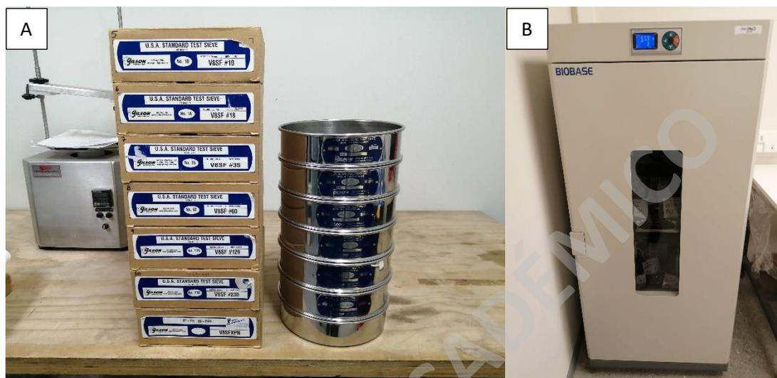
*Figura 11: Equipos utilizados en el procesamiento de tamizaje mecánico de las muestras de arena. A) Fotografía de la izquierda muestra las diversas grillas empleadas durante el proceso tamizado, ubicados en el laboratorio de simulación de la Escuela de Geología de la Universidad Mayor, Campus Manuel Montt. B) Fotografía de la derecha presenta el horno empleado para el secado de las diversas muestras, cuyas dimensiones corresponden a 600x550x1700 mm.*
